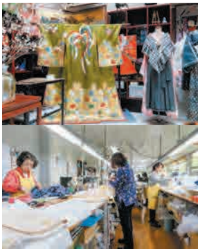
「座り仕事」から「立ち仕事」に転換し、体の負担を減らした縫製ライン。
